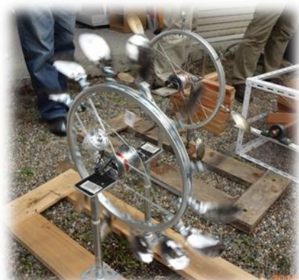
三茶屋ピコ発電 自転車車輪を利用したプロペラ式水車
