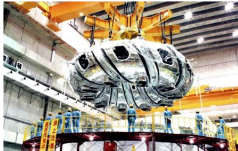
—大型ヘリカル装置の超伝導磁石(組立中の写真)—
