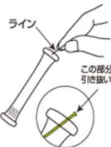
①チューブ先端のラインを引き抜きます。
